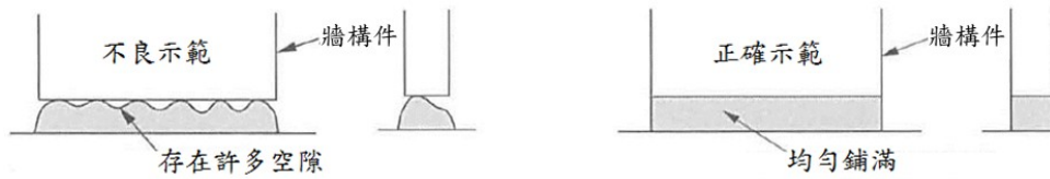
圖 R8.10 底鋪水泥砂漿之不良及正確示範 [8.4]
